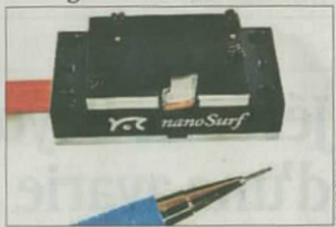
Les microscopes à effet tunnel et à force atomique (AFM), développés dès 1981 chez IBM Zurich, ont permis de voir et manipuler les atomes. La firme suisse Nanosurf a créé un AFM d'infime taille (image), installé sur la sonde Phoenix, qui a pris des images en résolution micrométrique de particules du sol de Mars.
